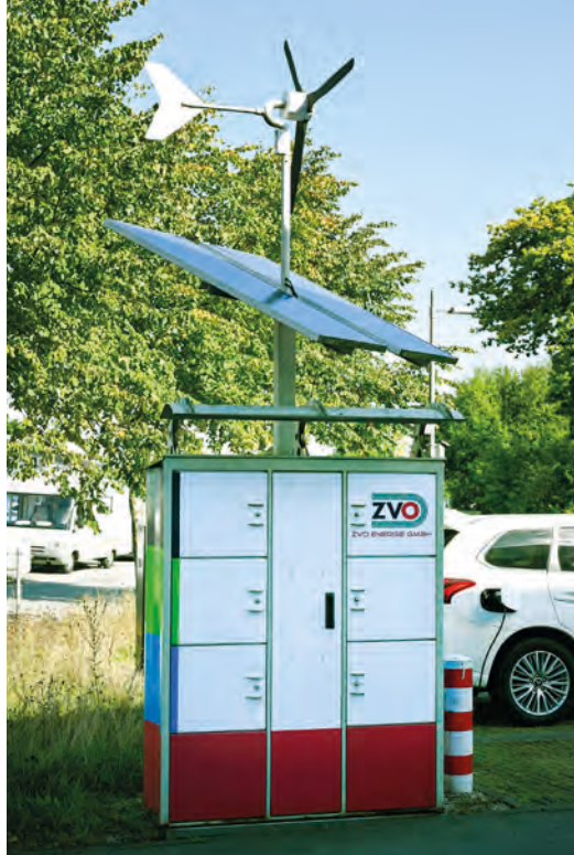
Autarker Ladeschrank für E-Bike-Akkus
