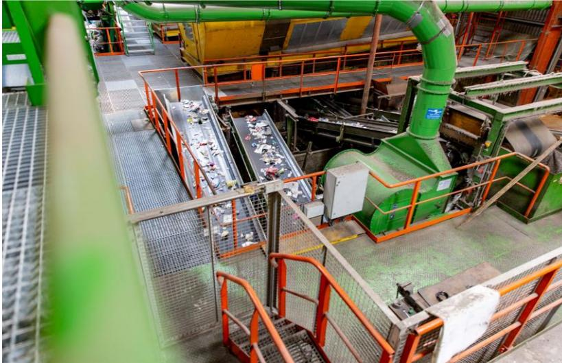
**In der LVP-Sortieranlage laufen die Verpackungen über verschiedene Bänder und werden nach Materialsorte getrennt.**
