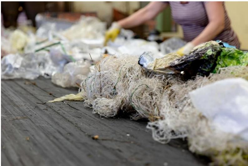
**Auf dem Zulaufband zur Presse sortieren Mitarbeiter mit der Hand erkennbare Fehlsortierungen der Anlage aus.**
